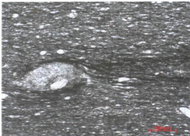
Photos 9 & 10: vue détaillée de l'ardoise - Analyse microscopique en lumière naturelle non polarisée Exemple de spécificité
