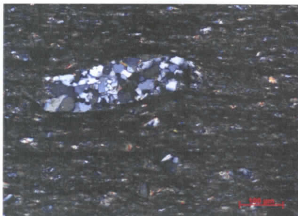
Photos 5 & 6 : vue détaillée de l'ardoise - Analyse microscopique en lumière naturelle non polarisée Présence de petits nodules de quartz
