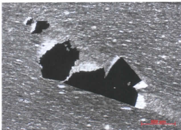
Photos 11 et 12: vue du schiste (ardoisier) - Analyse microscopique en lumière naturelle non polarisée (à gauche) et en nicols croisés (à droite) Exemple de spécificité
