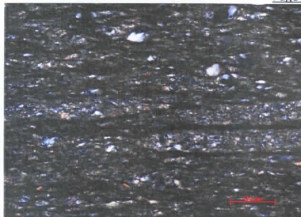
Photos 3 & 4 : vue détaillée de l'ardoise - Analyse microscopique en lumière naturelle non polarisée Présence de petits nodules de quartz, feldspath ou calcite
